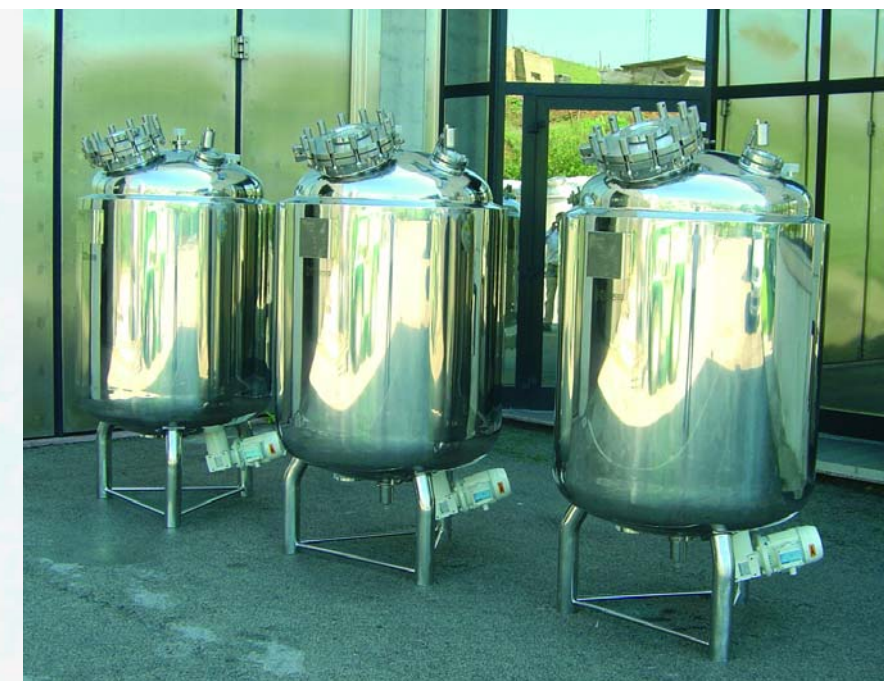
Preparatori da 500 lt. collaudato PED97/23/CE ▲ con quadro di controllo a bordo macchina Multipurpose Units 500lt. tested PED97/23/CE with control board on side machine
