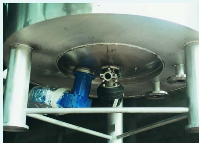
▲ Particolare agitatore magnetico e valvola di fondo pneumatica Detail of magnetic mixer and pneumatic bottom valve
