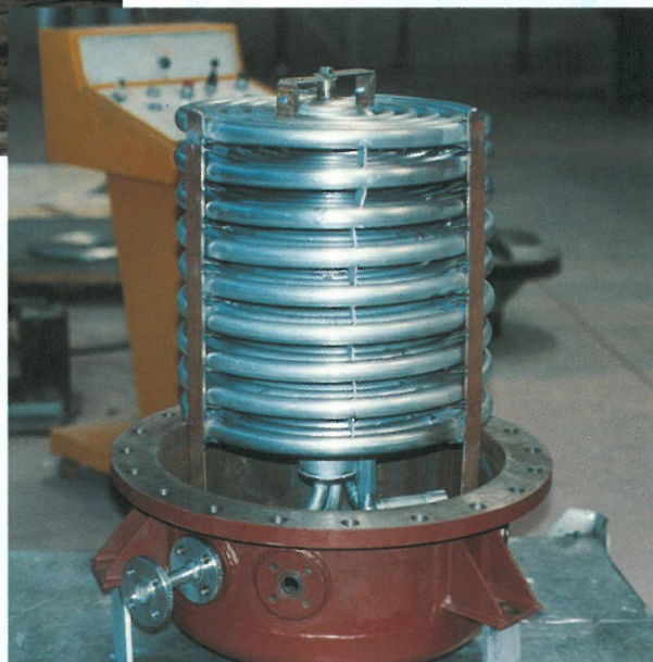
Particolare serpentino interno ▶
